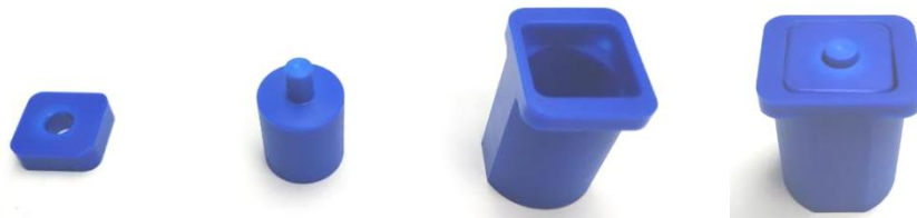
(1) 电机端盖 (2) 电机转子 (3) 电机外壳 (4) 电机成品
